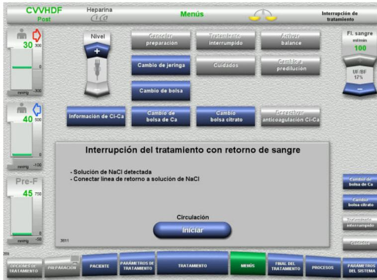
➤ Conectar la línea de retorno a la solución de NaCl.
