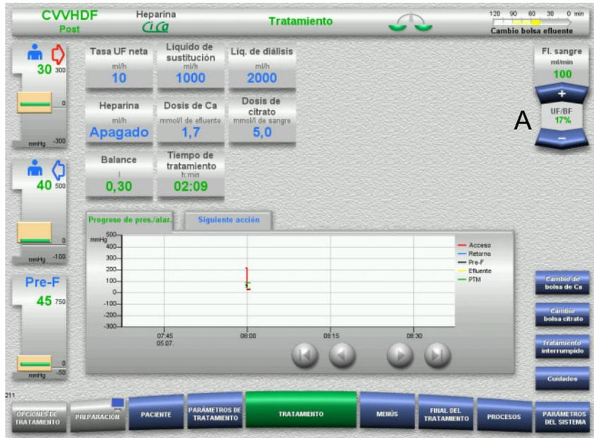
➤ Ajustar el flujo deseado mediante la tecla basculante (A) + / -.
