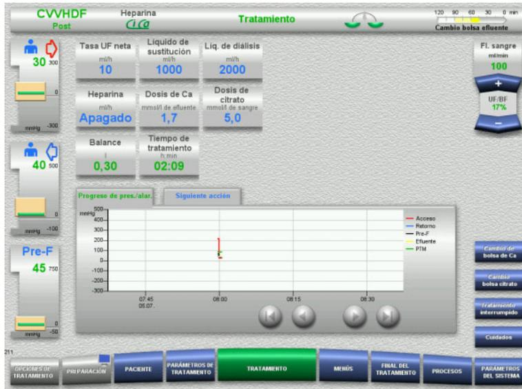
En **Progreso de pres. / alar.** se representan las presiones en el transcurso del tiempo. La visualización del progreso de la presión / alarma puede configurarse en los parámetros del sistema.
