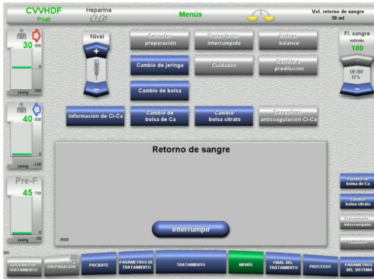
El retorno de sangre finaliza automáticamente cuando el detector óptico detecta solución de NaCl.
