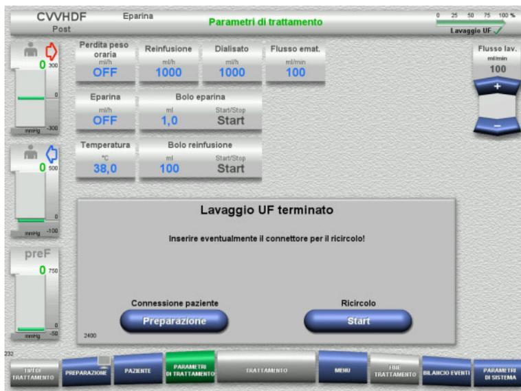
Una volta raggiunto il volume di lavaggio, la pompa sangue si ferma.
