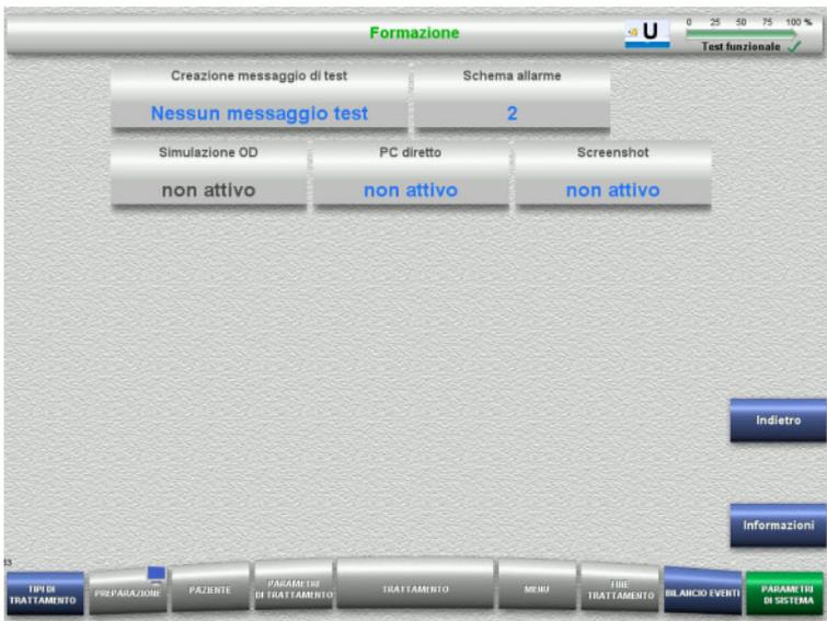
Nel menu **Formazione** è possibile impostare simulazione OD, schema allarme e messaggi di test.
