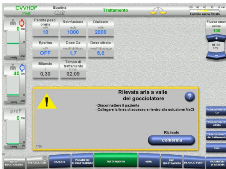
La presenza di aria a valle del gocciolatore sulla linea di rientro viene segnalata da un allarme acustico e da un messaggio.
