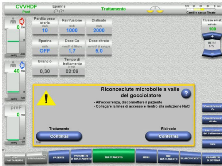
La presenza di microbolle a valle del gocciolatore sulla linea di rientro viene segnalata da un allarme acustico e da un messaggio.
