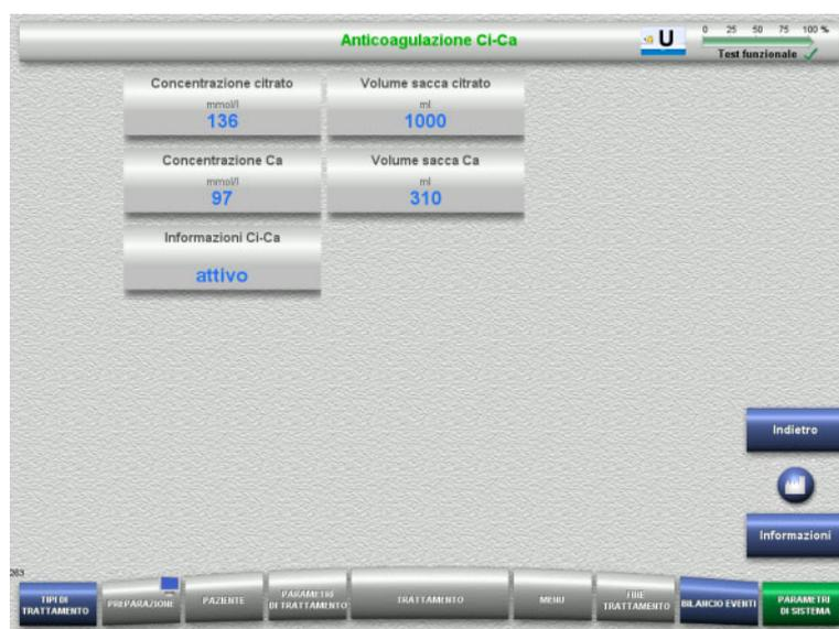
Con il tasto **Anticoagulazione Ci-Ca** è possibile impostare i parametri per l'anticoagulazione Ci-Ca.
