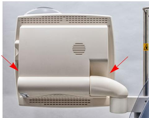
Per regolare e orientare il monitor occorre afferrarlo per le apposite impugnature integrate.
