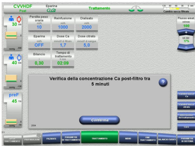
All'inizio del trattamento viene visualizzata un'indicazione che ricorda di controllare la concentrazione Ca 5 minuti dopo l'inizio del trattamento.
