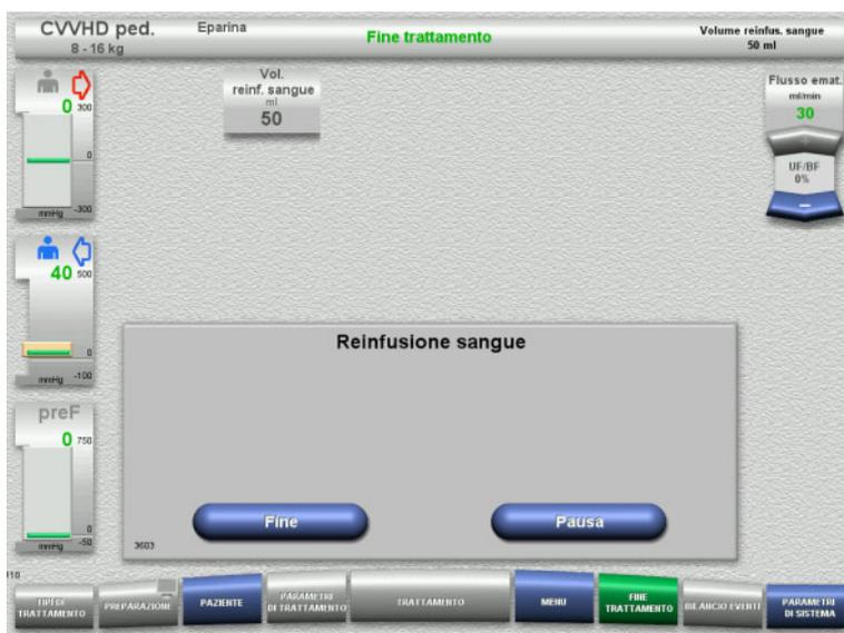
La reinfusione sangue si arresta automaticamente non appena il rilevatore ottico riconosce la presenza di soluzione NaCl.
