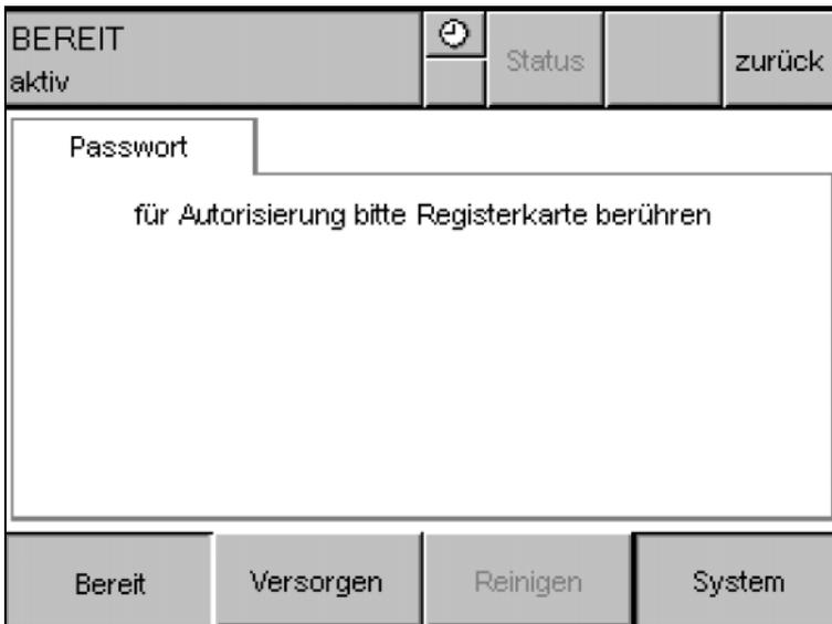
Mithilfe der Schaltfläche **System** öffnet sich die Bildschirm-Passwordeingabe.
