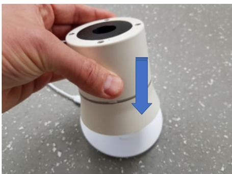
➤ Coloque el motor de la bomba en la estación de carga.
