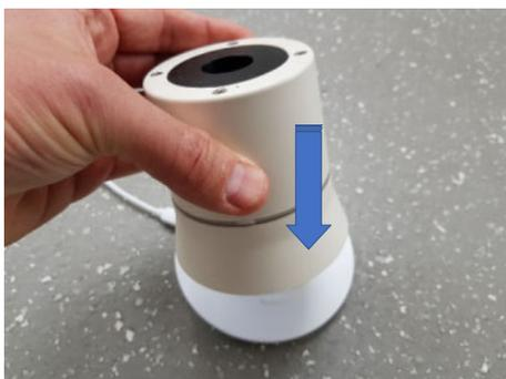
➤ Posizionare il motore pompa sulla stazione di ricarica.
