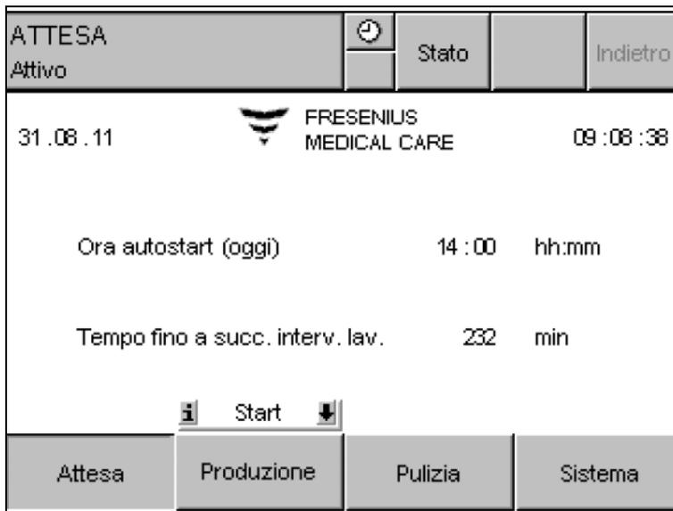
In modalità **ATTESA** l'elettronica è attiva, ma il dispositivo è tecnicamente ancora inattivo.
